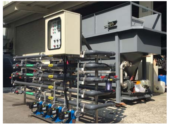
套裝型盤管式化學混凝設備-含化學幫浦,pH 控制與操控盤.並可銜接斜板置入式加壓浮除設備 (Lamella DAF)
